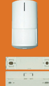
JS-20 - Czujka ruchu P.I.R. do ochrony pomieszczeń. Wykrywa ruch obiektów posiadających temperaturę ciała ludzkiego. Sygnał z czujki jest analizowany elektronicznie. To gwarantuje doskonałą czułość i eliminację fałszywych alarmów.
