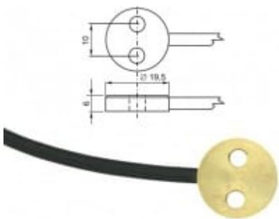
Sonda temperatury z czujnikiem Ni1000/6180 ppm. Mosiężna sonda do pomiaru temperatury powierzchni z kablem silikonowym o długości 15m, zakres -30 do 200°C. Średnica osłony 18mm, grubość 6.5mm. Mocowanie za pomocą wkręta M4 albo taśmy dwustronnej klejącej.
